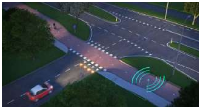
14. attēls. Labās prakses piemērs – autovadītājus brīdinoša gaismas signāla izvietošana pirms velocelņa.
